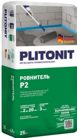
Продукт предназначен для выравнивания и корректирования бетонных полов и монолитных цементных стяжек внутри жилых и которских помещений под укладку напольной керамической плитки, выстилающих покрытий и паркета, а также использования в системе «теплый пол». Рекомендуемая толщина слоя при выравнивании — 2-20 мм, в углублениях — до 30 мм. Температура покрытия в процессе эксплуатации — от +5°C до +50°C
